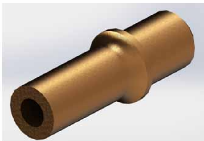
Рисунок 1. Заготовка форсунки. Рисунок 2. Законченная деталь
